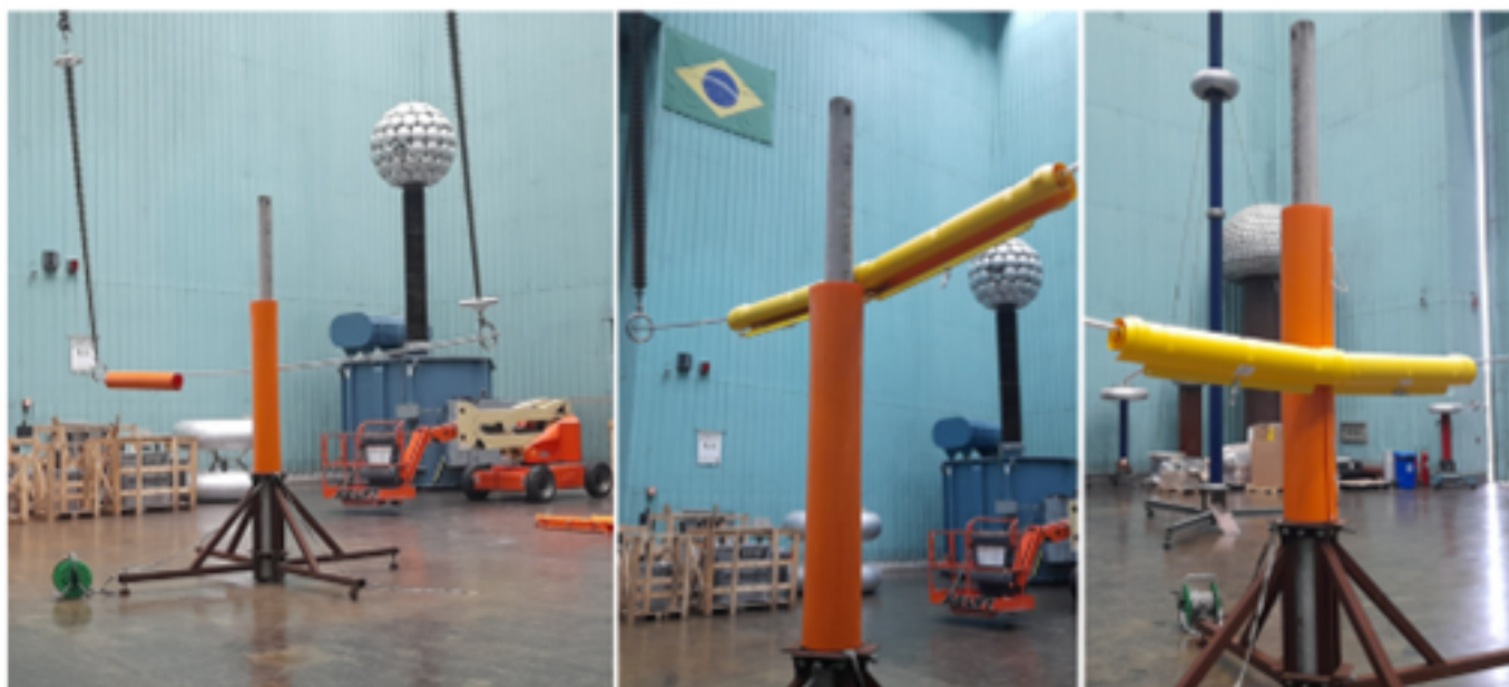
Imagem 6: Testes elétricos nas coberturas isolantes
